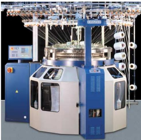
Tradizionale basamento Orizio modulare, rinnovato nella funzionalità, robustezza ed estetica, con nuovo pannello di controllo che permette la fruizione di nuove tecnologie ed integra il controllo macchina, la selezione delle platine e le seguenti funzioni:
